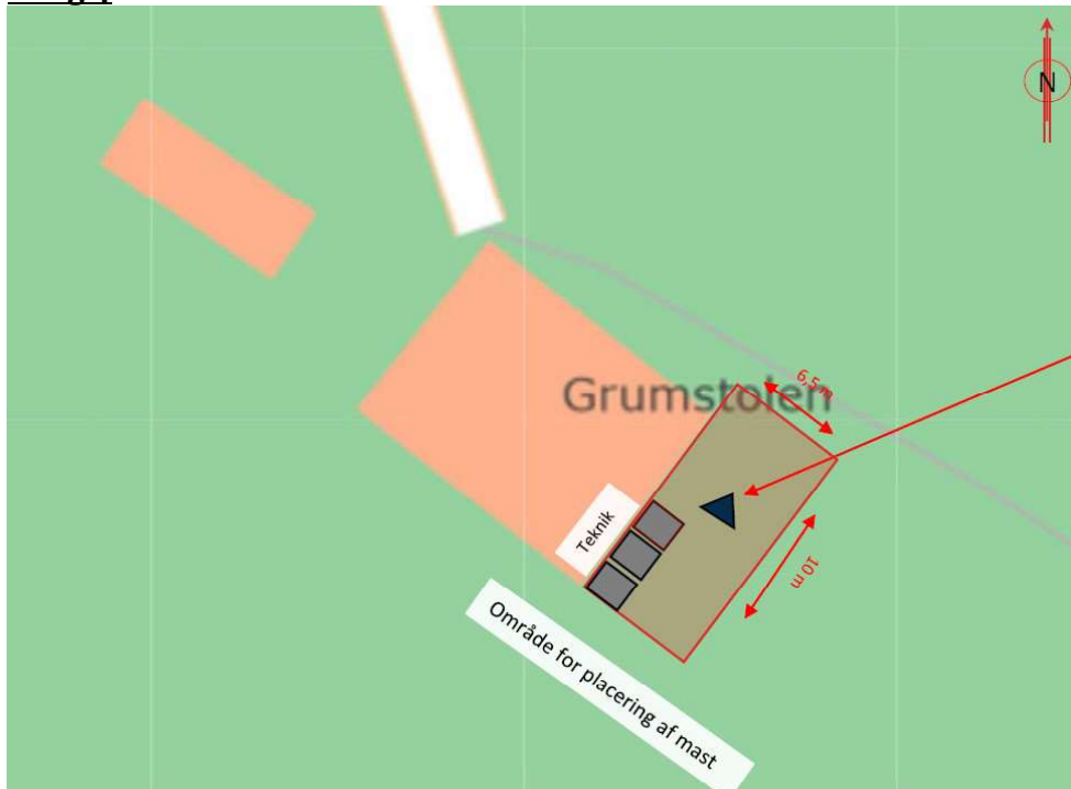
Udklip af materiale fremsendt til Miljøstyrelsen den 27. juni 2024, hvor det fremgår, hvor mast, teknikskabe og placering fremgår.
